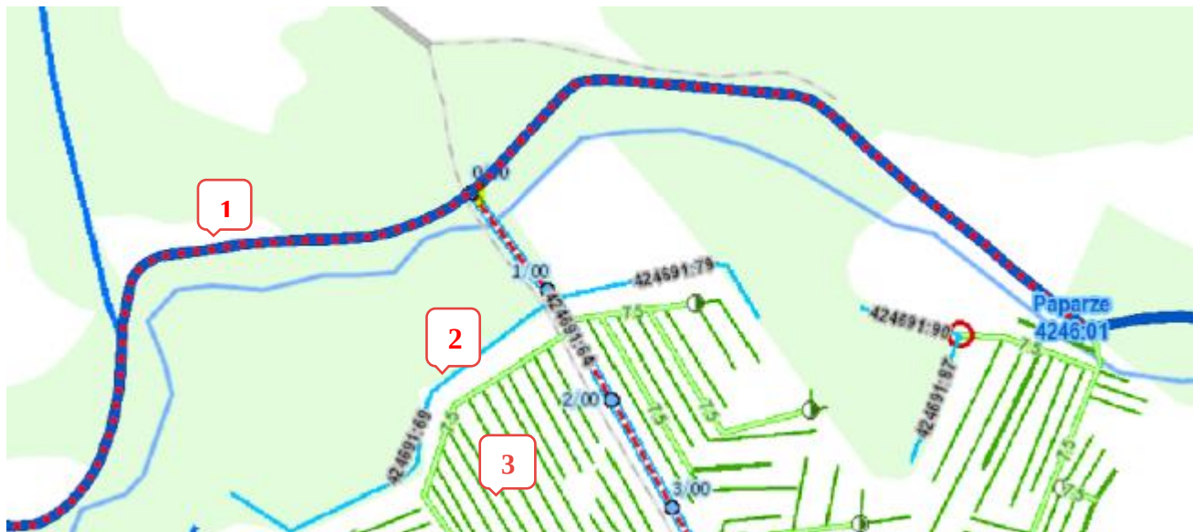
3.attēls. Meliorācijas sistēmu veidi 41 (1 – valsts nozīmes meliorācijas sistēma (ūdensnoteka), 2 – koplietošanas meliorācijas sistēma (grāvis), 3 – viena īpašnieka 42 (dreņu sistēma))
